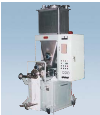
お客様の被包装粉に応じて、カスタムで設計生産されるオーガスクリュー
